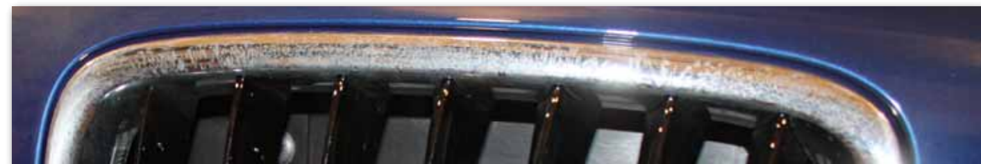
Bei dieser „Niere“ ist deutlich zu erkennen, dass es durch die Antragungen zu Oberflächenveränderungen gekommen ist. In diesem Fall ein irreparabler Schaden, der nur durch Tausch behoben werden konnte.
