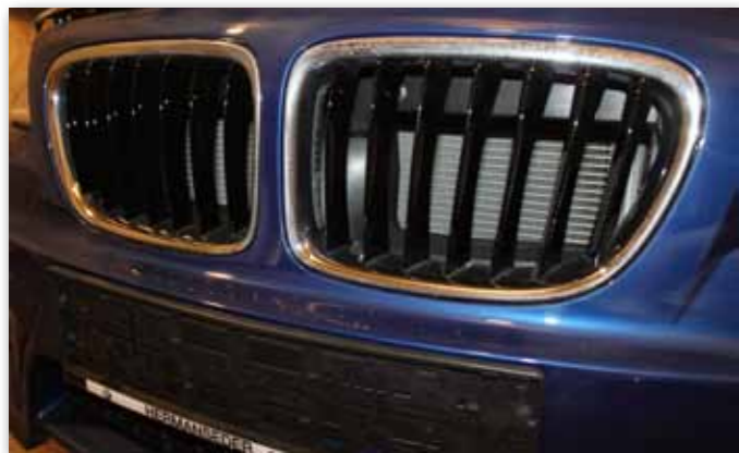
Bei dieser „Niere“ ist deutlich zu erkennen, dass es durch die Antragungen zu Oberflächenveränderungen gekommen ist. In diesem Fall ein irreparabler Schaden, der nur durch Tausch behoben werden konnte.
